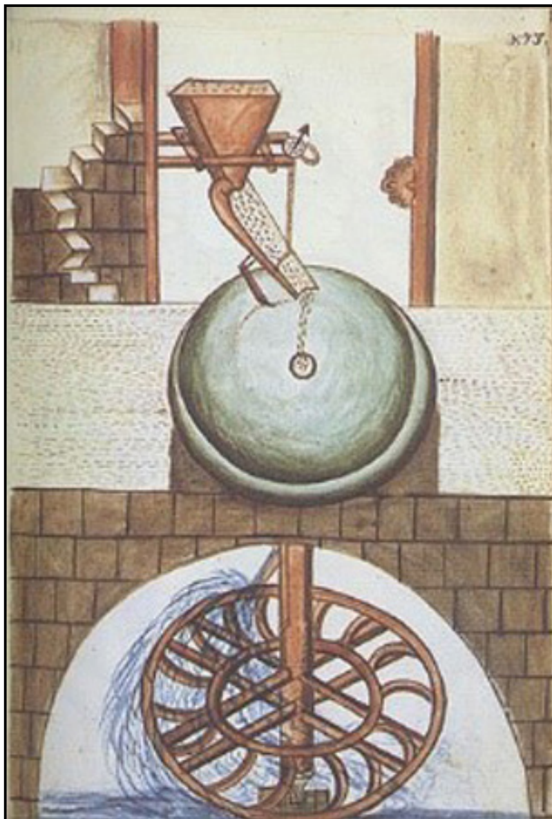
Figura 1. Molino hidráulico de rodeznó del Virreinato del Perú (siglo XVIII). Vista interna. Fuente: Martínez Compañón (1785).
